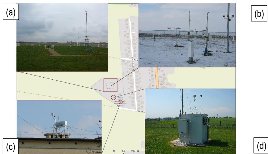
Obr. 7: Umístění měřicích zařízení na meteorologické stanici a stanici sledování aerosolů v Ratiboři Studzienna: (a) meteorologická zahrádka; (b) ceilometr; (c) radiometr; (d) kontejner pro měření aerosolů.
